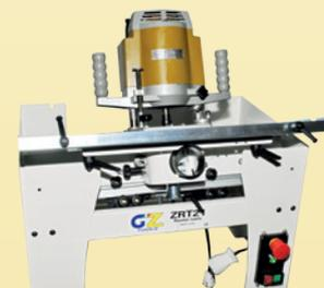
Il piano di lavoro si può ribaltare per permettere un'agevole sostituzione e/o regolazione dell'utensile.
