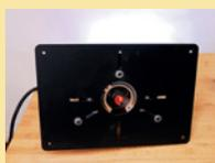
Può montare qualsiasi fresatrice portatile, dotato di una piastra in acciaio con scanalature per alloggiare le più comuni macchine in commercio, all'occorrenza potete forare la piastra per installare una macchina diversa.
