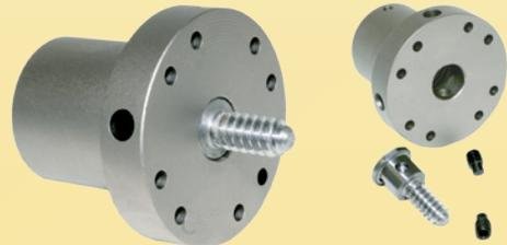
Si può usare come coda di maiale o come semplice platello: consiste nel fare un foro di preparazione Ø8 profondità 25 mm ed avvitare direttamente il pezzo sulla coda di maiale fino a far aderire bene il pezzo di legno al platello. Attacco filettato M33x3,5 mm (filettatura unificata europea DIN 800).
