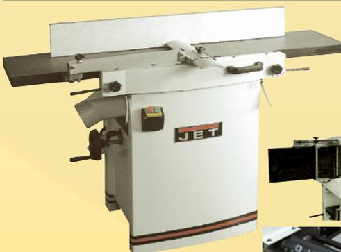
Piano in monoblocco in ghisa grigia, per cambio rapido da pialla a filo a pialla a spessore, perfetto allineamento dei piani. Trascinamento pezzo con rulli in acciaio ed in gomma. Guida inclinabile a 45°, solidale al piano. 56 coltelli in metallo duro disposti in modo elicoidale su tre principi per garantire un taglio fluido, 30% più silenzioso e una finitura impareggiabile. Coltelle reversibili a 4 lati.
