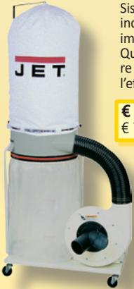
Sistema Vortex: il particolato (trucioli e polvere) viene incanalato verso il sacco di raccolta e la pressione impedisce al particolato di raggiungere il sacco filtro. Questo sistema permette di far rallentare e precipitare i trucioli e la polvere in modo rapido aumentando l'efficienza dell'aspiratore.
